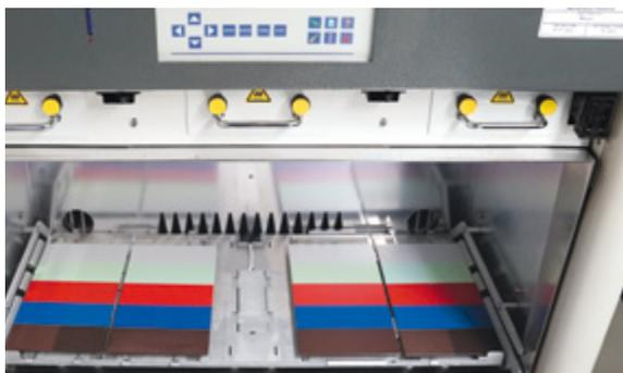
UV-Simulation im Testgerät
