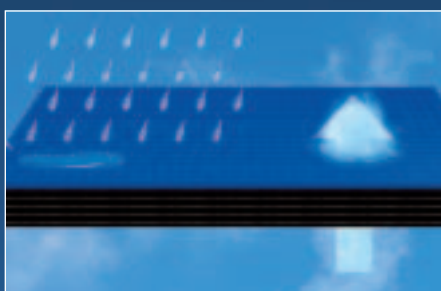
Hautement perméable à la vapeur d'eau (HPV) pour une pose au contact de l'isolant.
