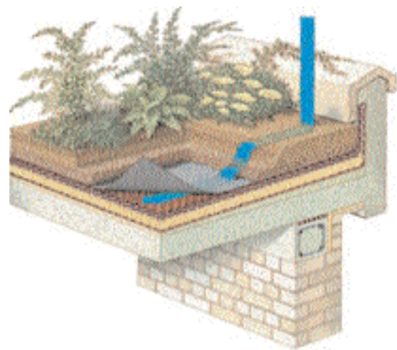
Sopra: schema generale di un giardino pensile su solaio isolato (elenco degli strati dal basso verso l'alto: massetto in cls, strato di pendenza in cls, strato impermeabile, isolamento, membrana alveolare con geotessile filtrante elettrosaldato - DELTA-DRAIN/DELTA-NP DRAIN, strato di terreno filtrante, terreno di riempimento, manto vegetale);
