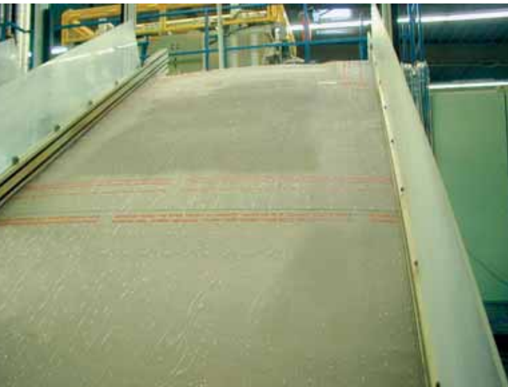
◀ Für die Qualität und die Sicherheit einer PP-Folie ist unter anderem eine intensive Qualitätskontrolle entscheidend. Dazu gehören zum Beispiel laufend durchgeführte Schlagregenprüfungen.
